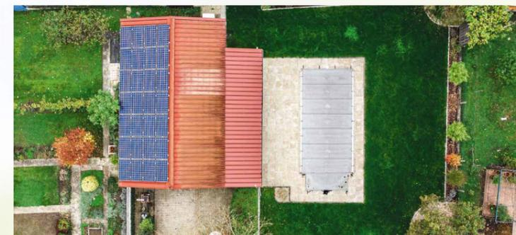
Mit der Photovoltaikanlage auf dem Dach des Gerätehauses wird eine spezielle Wärmepumpe betrieben, die das Wasser im Außenbecken des privaten Schwimmbads beheizt
